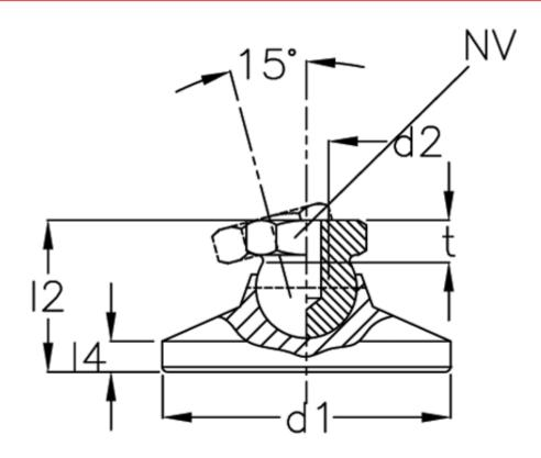
d1 = 40 d2 = 12 l2 = 26 l4 = 6 NV = 17 Static load (kN) = 33 t min = 11.5
